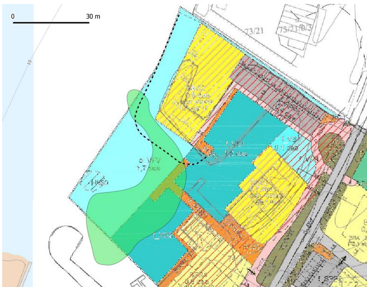
Figur 5.1. Fyllingsfoten (svartstiplet linje) vil gi direkte arealbeslag av ålegrasenga og dele forekomsten opp i to mindre deler.
